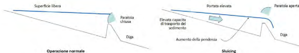
Figura 3.6: Rappresentazione schematica dell'operazione di sluicing (adattato da Kondolf e altri, 2014)
