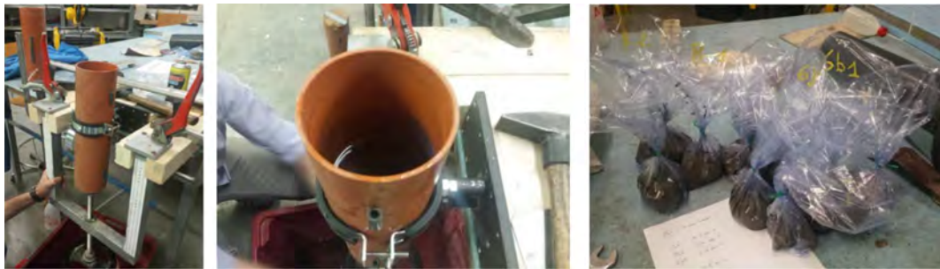
Figura 6.31: Operazioni di sezionamento delle carote di sedimento presso il Laboratorio di Idraulica dell'Università degli Studi di Trento
