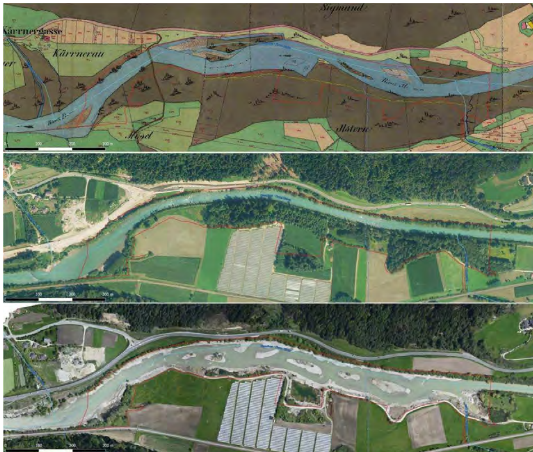
Figura 6.22: L'allargamento in zona "Istener Au" lungo la Rienza nella Bassa Pusteria (referenza 1858, prima dei lavori, al termine dei lavori eseguiti durante la stagione invernale 2019/2020) (fonte: Agenzia per la Protezione Civile)
