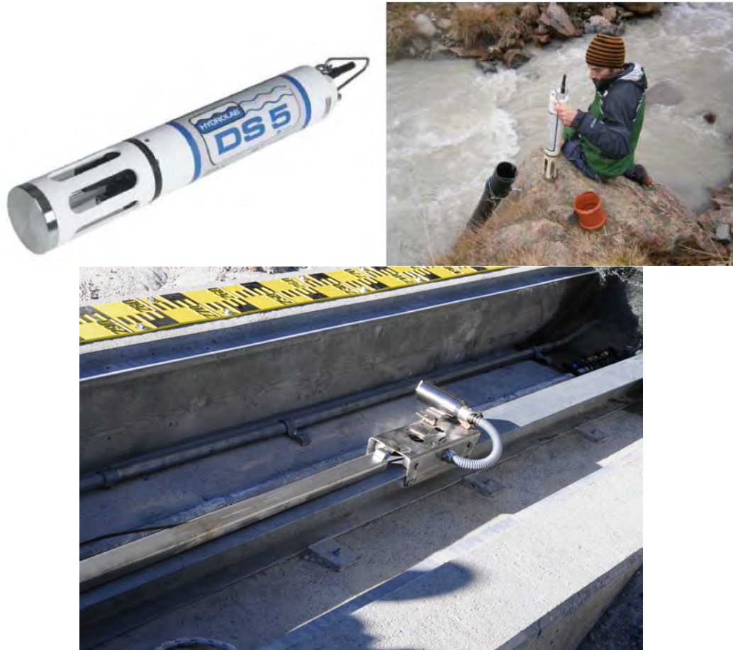
Figura 4.2: Monitoraggio continuo del trasporto solido in sospensione con l'utilizzo di un torbidimetro. Questo viene installato da un operatore e richiede una manutenzione più o meno frequente a seconda dell'intensità degli eventi di piena. Il torbidimetro può essere installato su un carrellino mobile lungo una rotaia per facilitare le operazioni di manutenzione (sotto)
