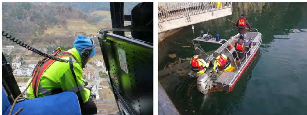
Figura 6.24: Immagini del volo fotogrammetrico e dei rilievi con ecoscandaglio
