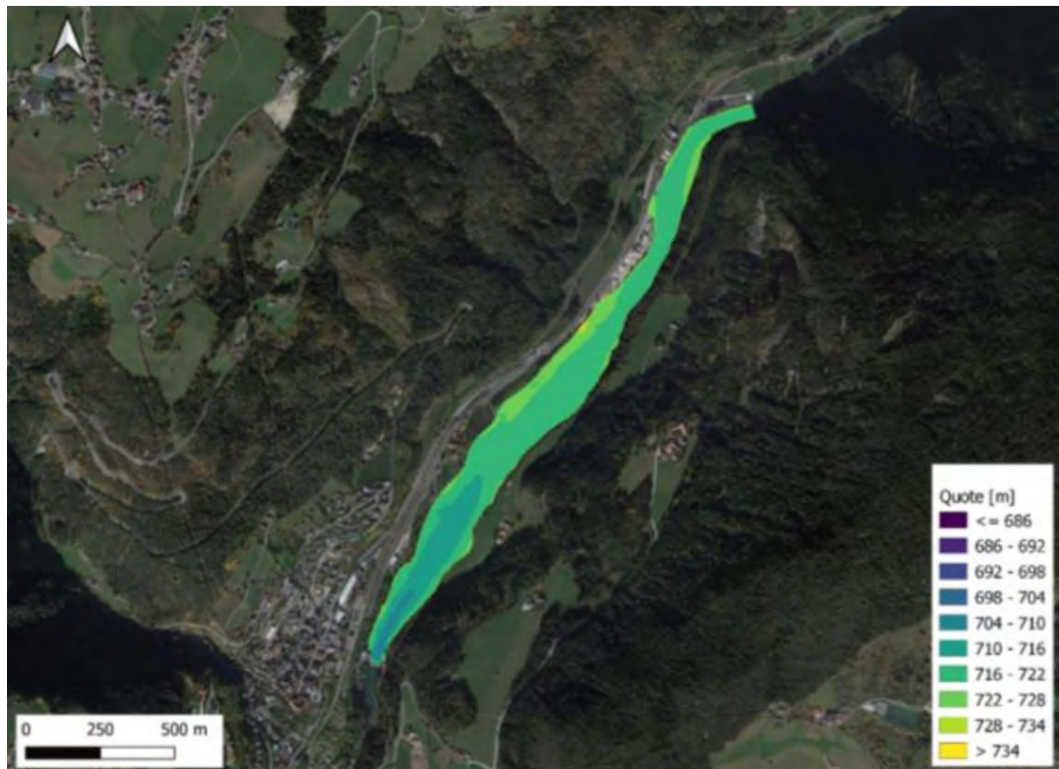
Figura 6.73: Vista dell'area di studio e DTM del bacino di Rio di Pusteria a Maggio 2019, pre-svaso
